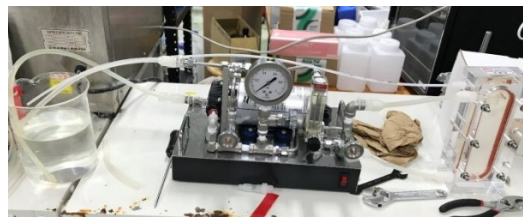
写真 5 プラスチック平膜テストセル装置図
