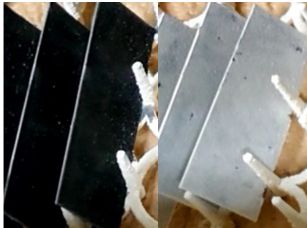
写真7 スケール付着の様子(左から付着前、付着後)
