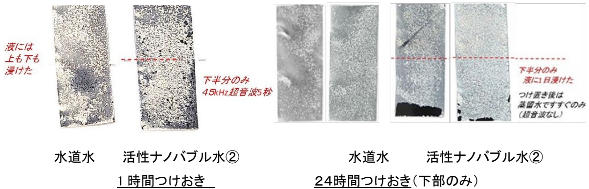
写真 9 スケール除去試験の結果
