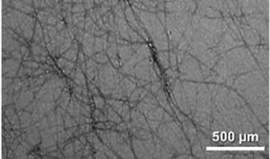
図3 spinifex 草を脱リグニン漂白処理後に水中解繊処理して得られる CNF の TEM 画像<sup>3)</sup>
