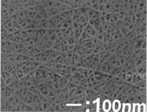
図4 グラインダー処理で木材から取り出した幅15-20nmのセルロースナノファイバー束
